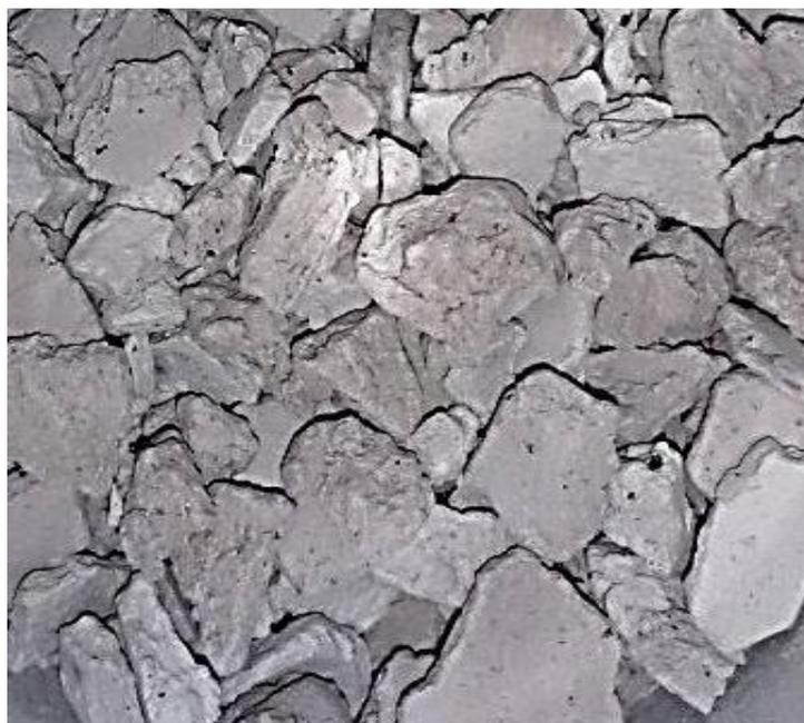
**Рис.** Медь-марганцевый катализатор для очистки воздуха от монооксида углерода
