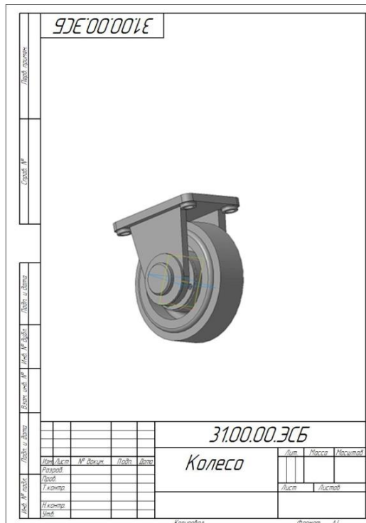
Образец выполнения задания КГ 7: сборочный чертеж электронной модели изделия
