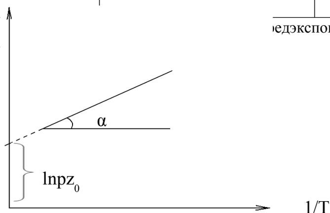
Рис. 1. Графический метод расчета энергии активации и логарифма предэкспоненциального фактора в уравнении Аррениуса
