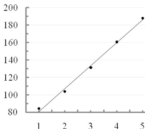
**Рис.1** Калибровочный график по МНК для кадмийселективного электрода
