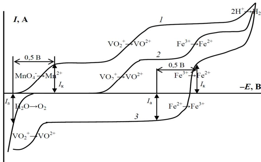
**Рис. 1.** Суммарные кривые  $I-E$  при титровании раствора, содержащего ионы  $\text{MnO}_4^-$  и  $\text{VO}_2^+$ , раствором  $\text{Fe}^{2+}$
