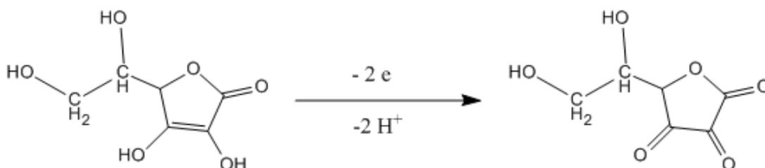
В качестве окислителя в данном методе используется элементарный йод, который количественно переводит аскорбиновую кислоту в дегидроаскорбиновую кислоту по реакции:
