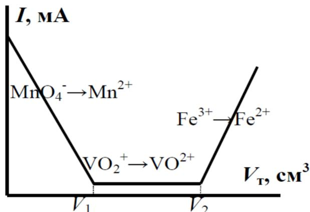
Рис. 2. Кривая титрования  $\text{MnO}_4^-$  и  $\text{VO}_2^+$  раствором  $\text{Fe}^{2+}$
