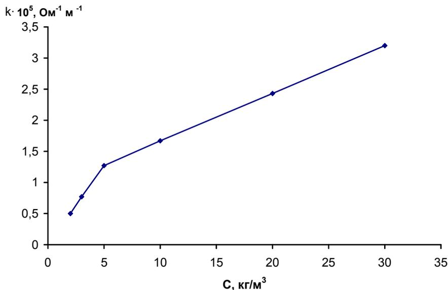
Рис. 9. Графическое определение ККМ раствора лаурата натрия
