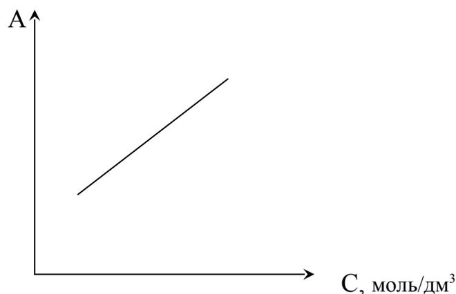
Рис. 2. Зависимость оптических плотностей экстрактов от концентрации ПАВ
