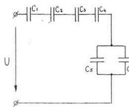
$U=133$  В;  $C_1=95$  мкФ;  $C_2=95$  мкФ;  $C_3=40$  мкФ;  $C_4=75$  мкФ;  $C_5=60$  мкФ;  $C_6=60$  мкФ.
