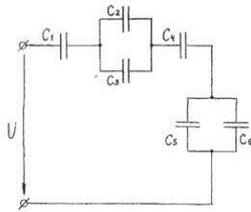
$U=260$  В;  $C_1=95$  мкФ;  $C_2=95$  мкФ;  $C_3=50$  мкФ;  $C_4=75$  мкФ;  $C_5=85$  мкФ;  $C_6=60$  мкФ.
