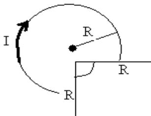
**Задача 299.** По плоскому контуру из тонкого провода течет ток силой  $I = 100$  А. Определить магнитную индукцию  $B$  поля, создаваемого этим током в точке  $O$ . в случаях, указанных на рис. . Радиус изогнутой части равен  $R = 20$  см.
