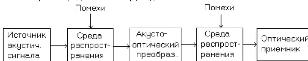
Рис. 1. Структурная схема канала утечки информации
